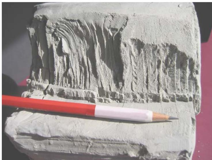
Figure 3.1. : Photo d'une carotte dans une série glacio-lacustre à laminations millimétriques des Losiardes, Claie-aux-Moines. La carotte non pelée est recouverte de boue et les laminations sont complètement masquées. On observe également sur le bord des laminations les crochets de déformation dus à la pénétration dans le carottier.
