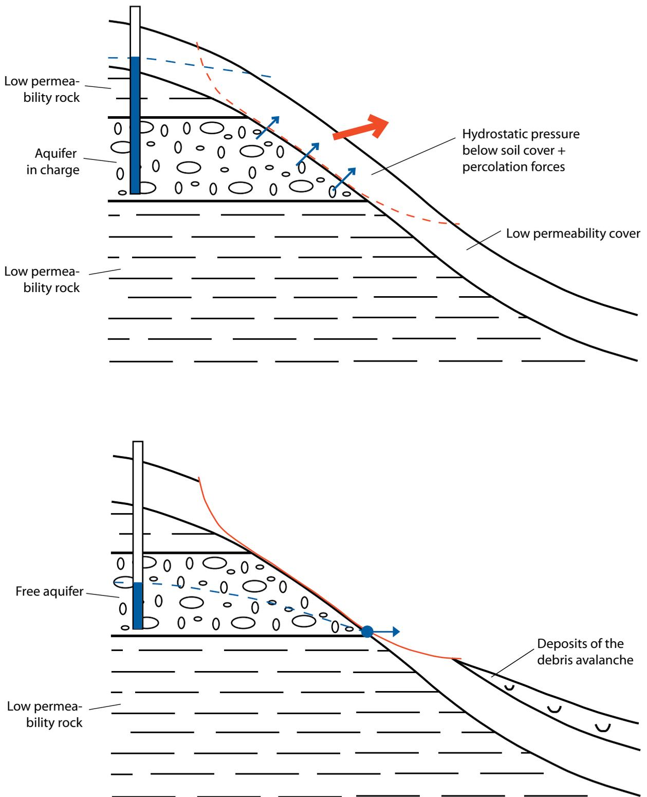
Fig. 5.5.6 : Mechanism of a debris avalanche.
